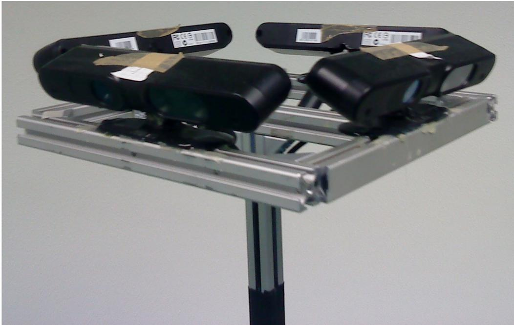
Abbildung 5.1: Rundumsicht durch vier Kameras
