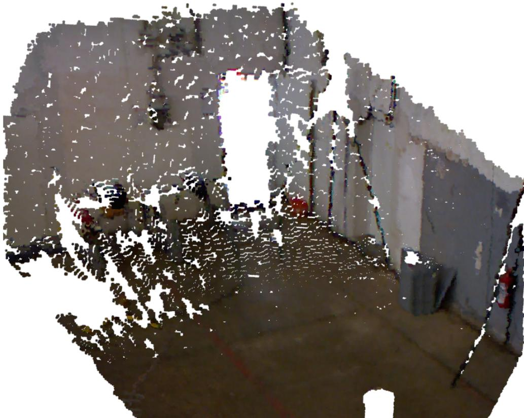
**Fig. 1.1:** Diskretisierungseffekt bei zunehmender Tiefe
