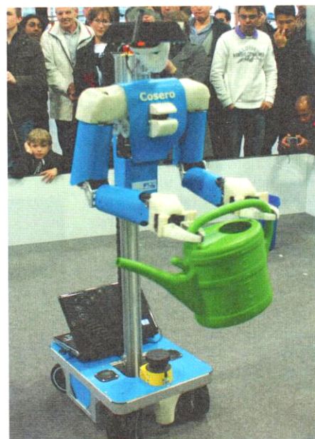
Dank eines 3D-Scanners konnte der NimbRo-Roboter selbstständig Modelle der Gegenstände lernen, mit denen er hantieren soll.
