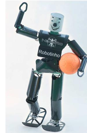
Den Roboter Robotinho haben wir für die Teen-Size-Klasse entwickelt. Er ist 100cm hoch und wiegt nur 5,2kg. Der Roboter hat 23 Gelenke: 6 in jedem Bein, 4 pro Arm und 3 im Rumpf. Er kann die Gelenkstellungen mit Potentiometern messen. Weitere Sensoren messen die Motortemperaturen, die Akku-Spannung, sowie Beschleunigungen und Drehraten. Daraus
